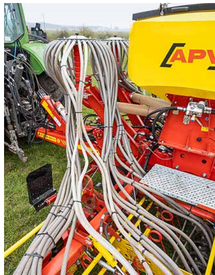
Zwei Verteilerköpfe versorgen insgesamt 60 Säschar.
