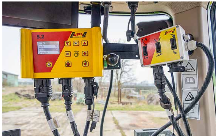
Die Kipphebelbox wechselt die Funktionen der Steuergeräte, der Bordcomputer steuert das Säaggregat.
