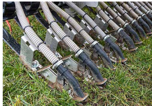
Die neue Säschiene mit Schlitzmessern und Furchenformern hat 12,5 cm Reihenabstand.
