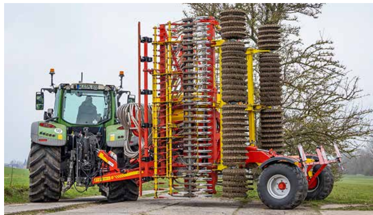
Für den Transport klappt die GP 750 kompakt – allerdings auch auf 3,95 m Höhe.
