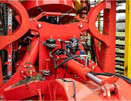
Stickstoffdämpfer in der Fahrwerkshydraulik dienen als Federung.
